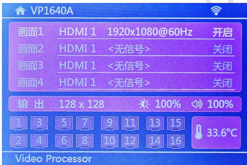
下一栏图标从左到右依次为：输出大小，亮度，声音，网口使用状态，机箱内部温度。
